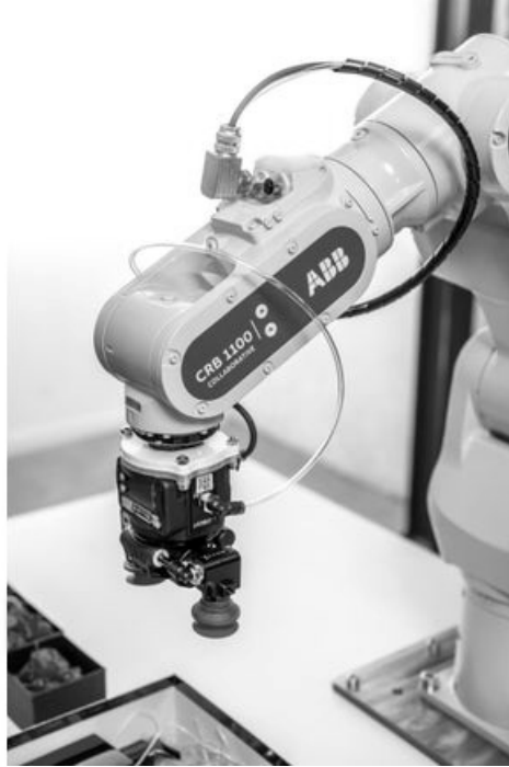
Figura 1.2. Brazo robótico de manipulación de piezas (ABB)
