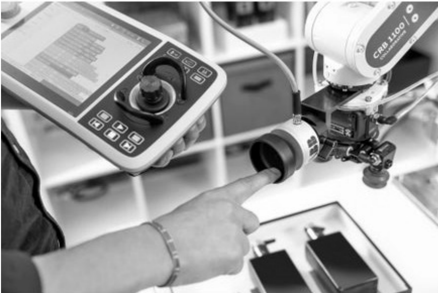
Figura 1.3. Robot cobot manipulado desde una tableta (CBR)
