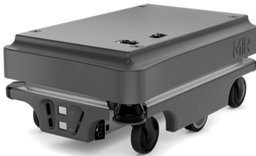
Figura 1.4 Robot móvil (MR)
